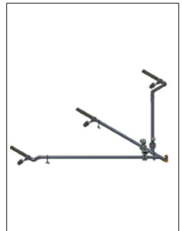
Fittings til pumpe og 3 tank
