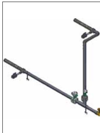
Fittings til pumpe og 2 tank
