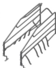
Farelad F200S uden vippebøjle, med overbygning L1 (inkl. baglåde): 2300 mm L2 (inkl. baglåde): 1900 mm
