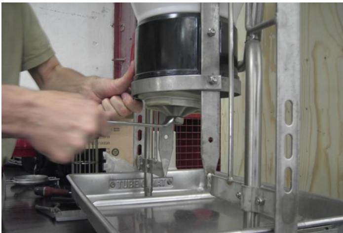
8 mm låsemøtrik afmonteres og foderrondel drejes af (mod venstre)
