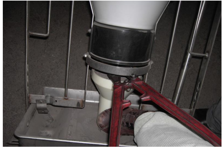
Er dette ikke muligt, frigøres hele klokken ved at klippe justerstangen over med en boltsaks, alternativt med en vinkelsliber
