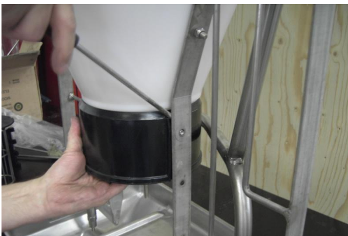
8 mm møtrik fjernes og bolte skubbes ind. Herefter frigøres kraven som vist med en stor ligekærvs-skruetrækker, alternativt ved at slå boltene gennem rammen med hammer og dorn.
